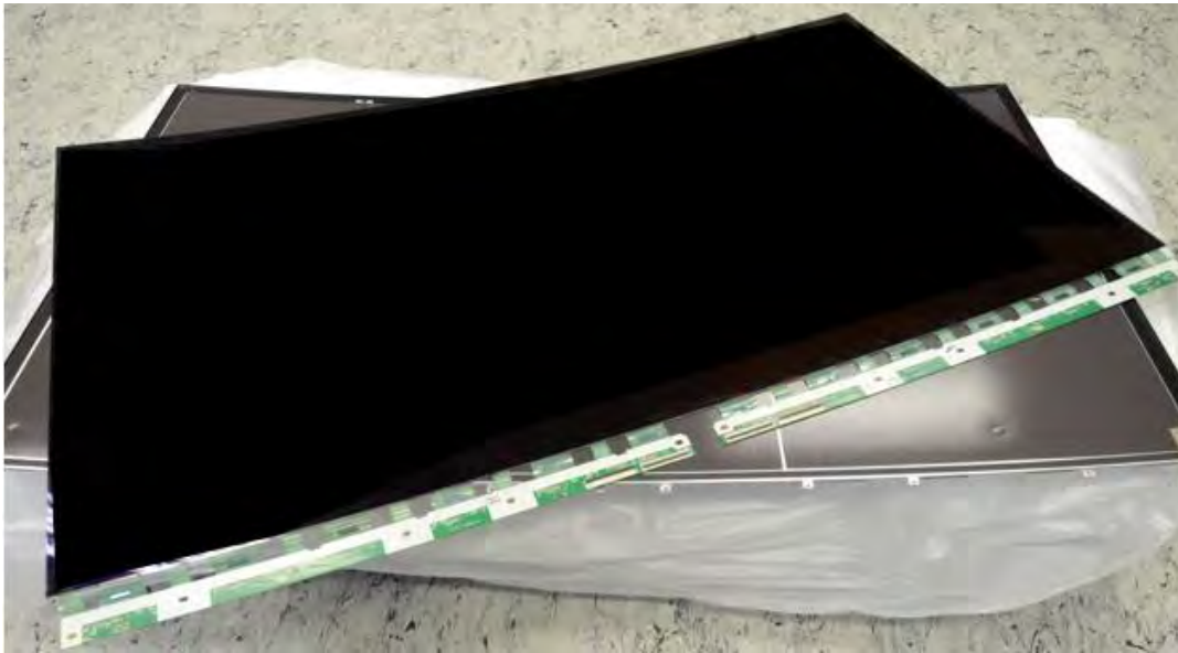
Abbildung 54: Separierung des Displaypanels des OLED TV vom stützenden Gerüst
