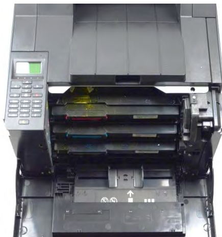
Abbildung 59: Schubfächer für Tonerkartuschen anhand DUT_7 und DUT_8
