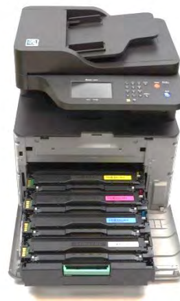
Abbildung 59: Schubfächer für Tonerkartuschen anhand DUT_7 und DUT_8
