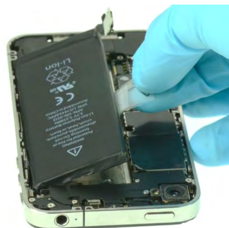
Abbildung 36: Arbeitsschritte zur Entnahme eines integrierten Akkus anhand DUT_6
