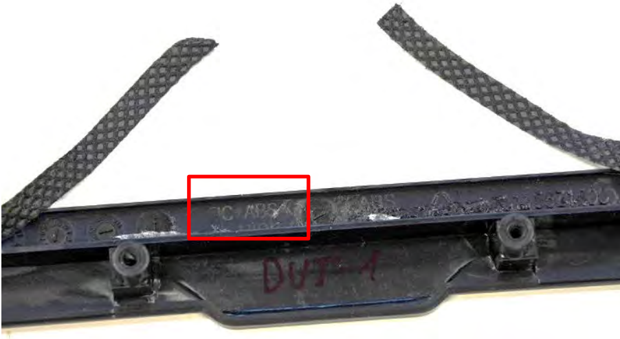
Abbildung 49: Beispiel für eine nicht unmittelbar einsehbare Kunststofftypenkennzeichnung
