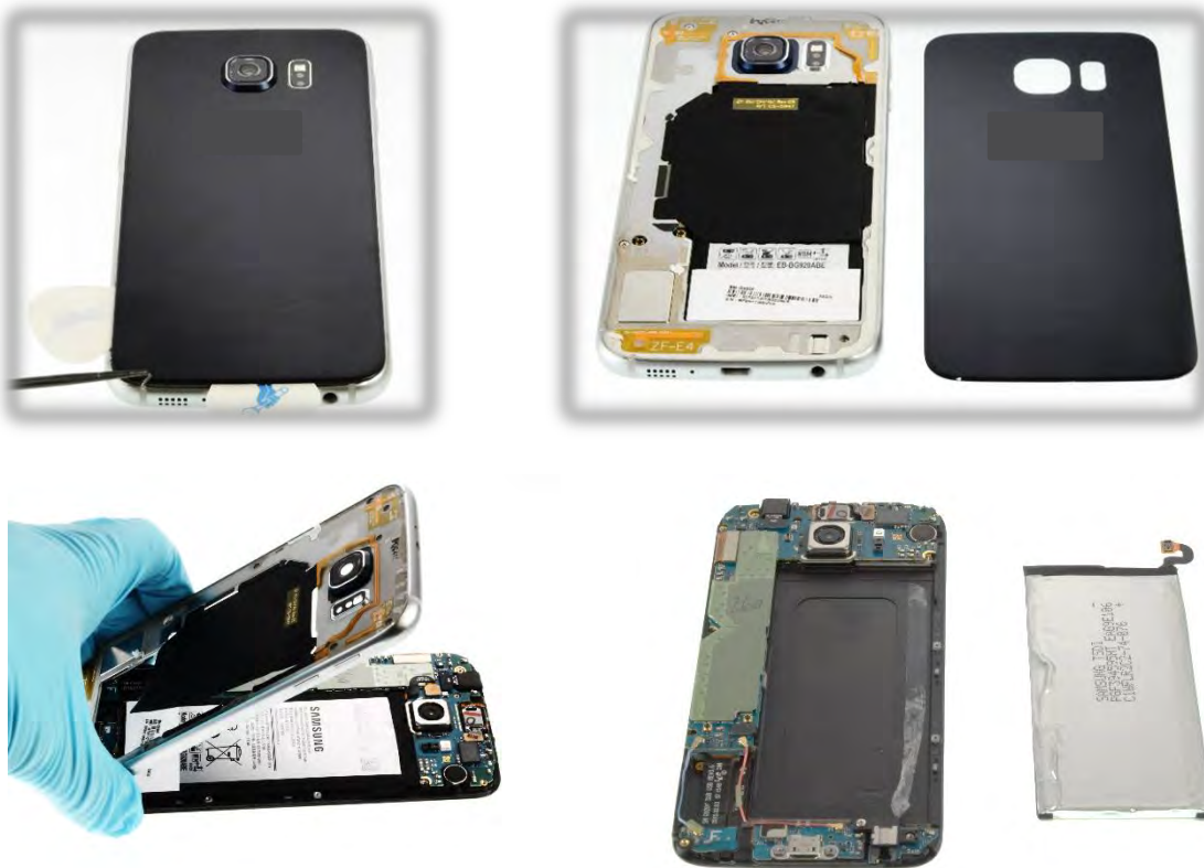
Abbildung 38: Entnahme eines integrierten Akkus anhand DUT_1
