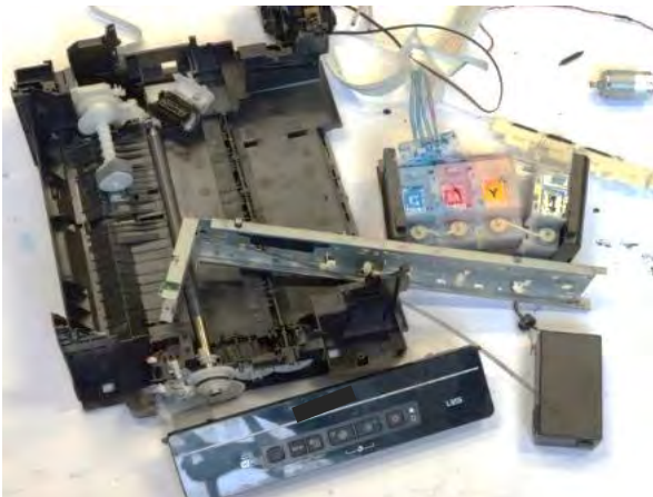
Abbildung 58: Entnahme der Tintenpatronen anhand DUT_1 und DUT_5
