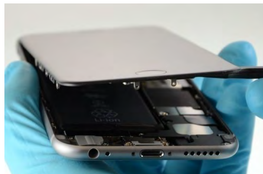
Abbildung 41: Entnahme eines Smartphone Displays anhand DUT_7
