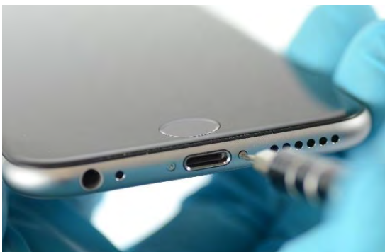
Abbildung 41: Entnahme eines Smartphone Displays anhand DUT_7
