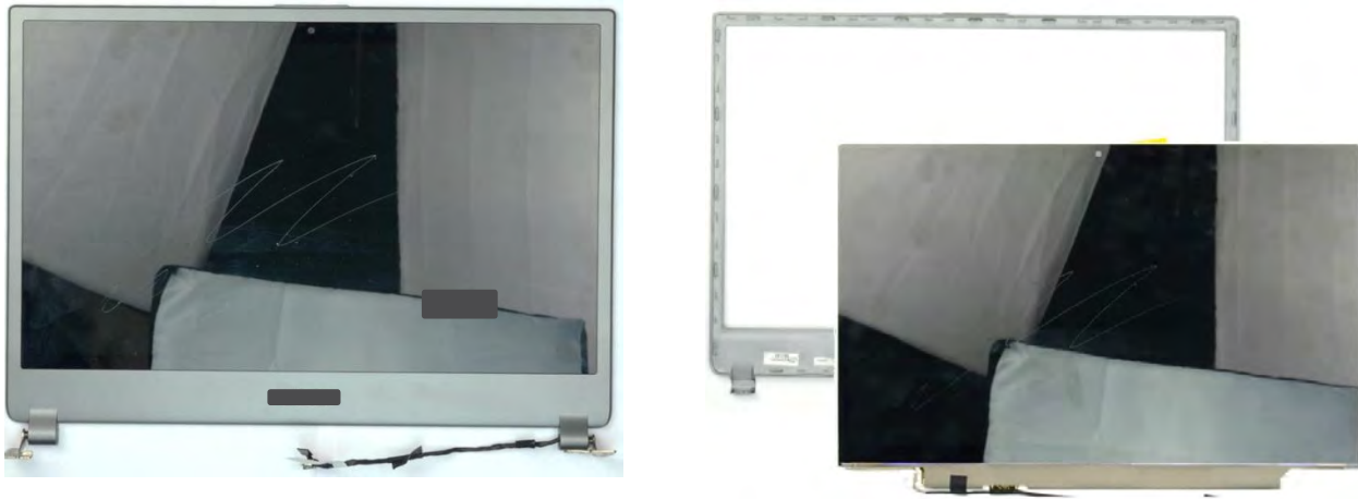
Abbildung 30: Separierung des Displaymoduls von Gehäuseteilen anhand DUT_5
